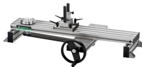
El **dispositivo mecánico de accionamiento** permite fijar y accionar la llave dinamométrica de manera rápida y precisa. El dispositivo mecánico de accionamiento garantiza, entre otras cosas, que a partir del 80 % del par de apriete nominal definitivo, la fuerza pueda aplicarse de forma lenta y constante dentro del plazo exigido, según establece la norma DIN EN ISO 6789 para llaves dinamométricas con disparo.
