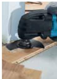
Cortes al ras de la superficie para instalación de pisos, por ejemplo.
