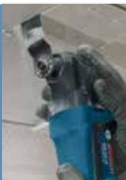
Cortes fáciles y precisos en lugares difíciles para encaje de enchufes, cerraduras, etc.
